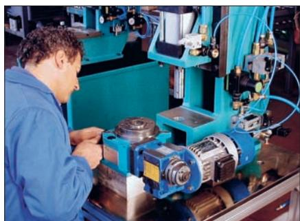
Alle mechanische Rundschalttische G.P.A. können in Verbindung mit Pneumatische-bzw. Hydropneumatischenpressen der G.P.A. Verarbeitungssysteme mit höherer Taktzahl erstellen; in die nachfolgende Bilder sind Maschinen dieser Art mit Pressen von 20 bis 70 kN.
